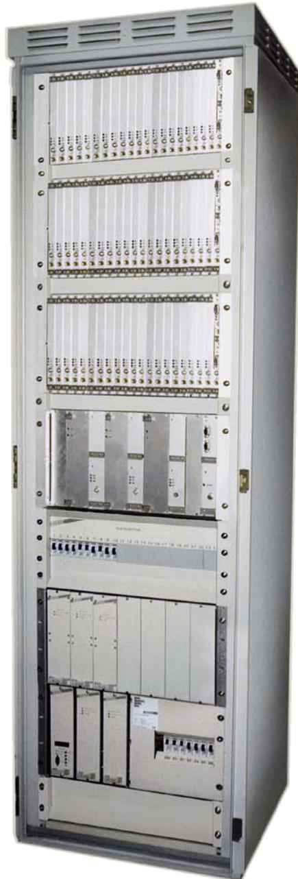
Система микропроцессорной централизации МПЦ-2 на базе УВК ЭЦМ предназначена для централизованного управления средствами вычислительной техники объектами низовой и локальной автоматики - стрелками, сигналами, переездами и т.д. - на железнодорожных станциях.
